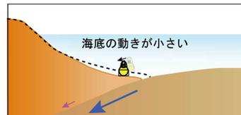
陸と海のプレートの固着の強弱により、陸側のプレートに設置した海底局の移動距離に差が出る。
