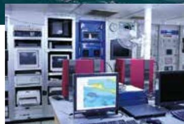
■船内にはマルチビーム測深機、サイドスキャンソナー、深海用音波探査装置などで収集したデータの読み取り、記録、処理用の機材がところ狭しと並んでいる
